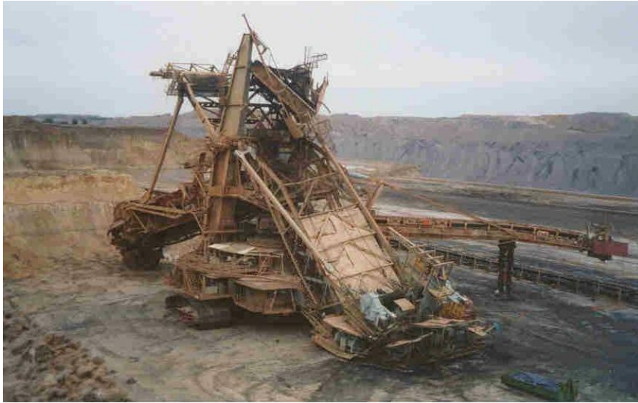
Abb. 27: Schaufelradbagger, Einsturz nach Reparatur (aus Gutachten, Ersteller SP)
