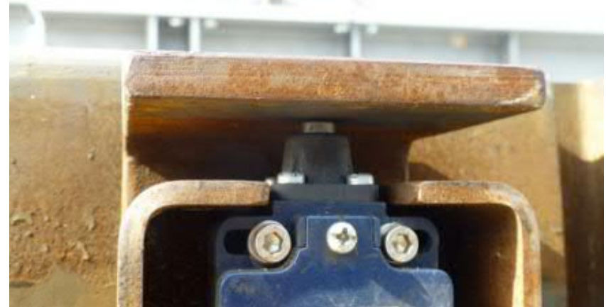
Zulässiger Höhenversatz Schienen: 2 mm
